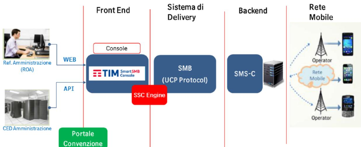
Figura 3 – Architettura applicativa della piattaforma SMS massivi.
